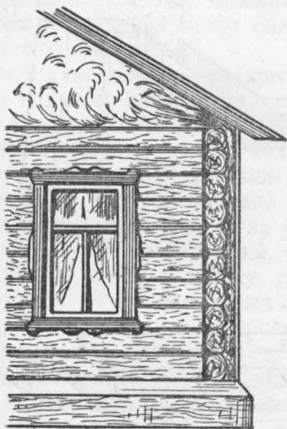
Рис. 11. Распространение пожара под подшивкой наружной стены.
